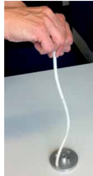
Bild 1: Freihandversuch zur Illustration des freien Moments
