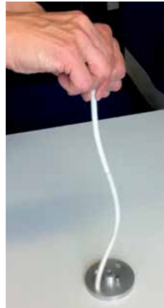
Bild 1: Freihandversuch zur Illustration des freien Moments
