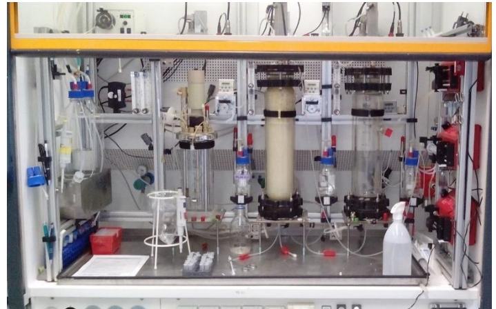
Abb. 1: Versuchsaufbau im Labor mit 2x2L Blasensäulen und Fermenter, nicht abgebildet: Gasmischstation zu beliebigen Mischung vom Butanmischgas. Bedingt durch die Brennbarkeit von Butan ist der Versuchsaufbau in einem Abzug aufgebaut.
